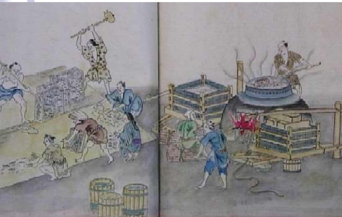
「搾糟製造之図」。搾粕(×粕)の製法。とれたイワシを大釜で煮込み、油をしぼった後、二、三匹ずつ手でほぐし、天日に干す。油は灯火用。ほかにムシロに広げて干して作る干鰯がある。
